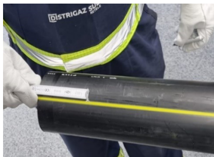
Figura 15. Măsurarea conductei de PEHD
