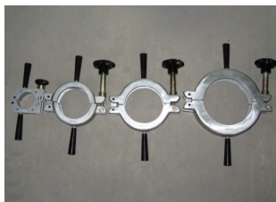
Figura 11. Dispozitive de re-rotunjit de diferite dimensiuni pentru conducte de PEHD
