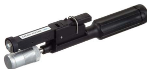
Figurile 18. Dispozitiv de rașchetat capete de conducte de PEHD
