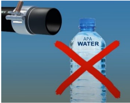
Figura 21. Degresare incorectă realizată cu apă
