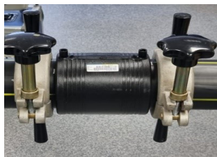
Figura 10. Utilizarea dispozitivelor de re-rotunjit conducte de PEHD
