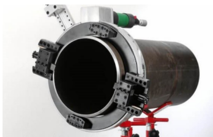
Figura 31. Dispozitiv pneumatic de debitat și șanfrenat conducte din OL cu DN 3"-8" / 6"- 12"
